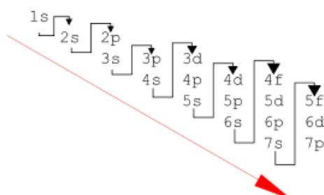
Diagramme de Klechkowski, donnant l'ordre de remplissage des sous-couches électroniques le long des flèches jusqu'à la sous-couche 7p.
